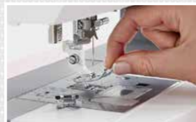
Byt enkelt pressarfot med snap-on-systemet
